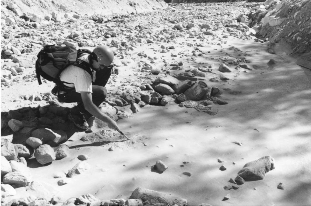
**Figure 1-7:** Prélèvement dans un dépôt frais (encore mou) dans l'Ilgraben (photo M. Sartori).
