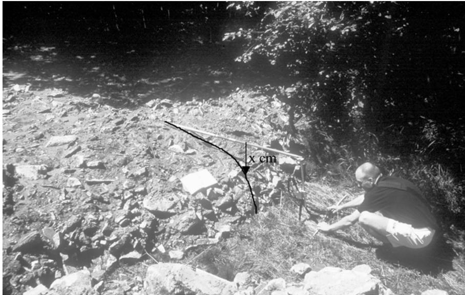
**Figure 6-14:** Mesure d'un bourrelet latéral sur le torrent de Batsoule. La mesure est prise à partir d'une référence horizontale.
