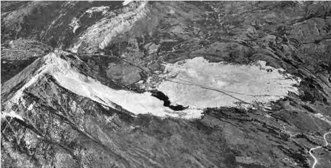
**Figure 2-10:** Illustration de l'ambiguïté de la traduction des termes. L'éboulement de Frank, Alberta, est décrit comme une chute de roche (*rock fall*) qui s'est ensuite propagée comme un *debris flow* (photo Natural Resources of Canada).
